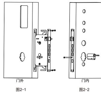
2-3 后锁安装反锁拨片(反锁拨片和开口锁在配件包中)，并根据门厚确定8\*8方轴长度、锁芯传动轴长度、反锁拨片长度，并确保后锁面把手孔内有放方轴顶黄。
